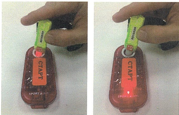
Рис. 3 и 4. Работа бесконтактной станции (финиш) и зелёный индикатор подключения бесконтактного режима.
